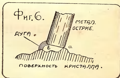
Микроскопическая дуга генерирующего кристалла. Сильно увеличено.
